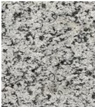
الشكل 7: صور المجهر الضوئي لعينة القضاض من قلعة صيرة عند تكبيرها \times 100 .
