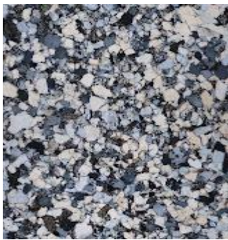
الشكل 7: صور المجهر الضوئي لعينة القضاض من قلعة صيرة عند تكبيرها 100×.
