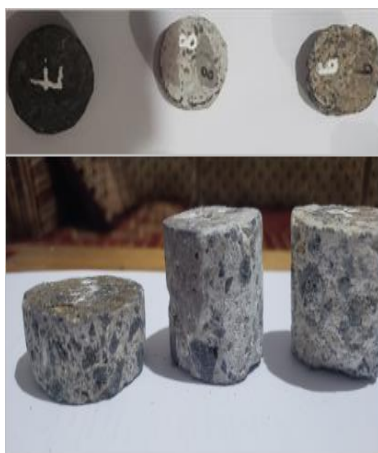
الشكل (4): عينات مادة القضاض من قلعة صيرة، المحضرة للاختبارات المعملية
