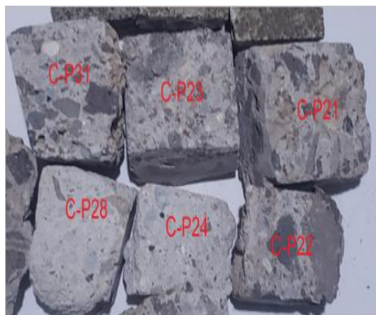
الشكل (4): عينات مادة القضاض من قلعة صيرة، المحضرة للاختبارات المعملية
